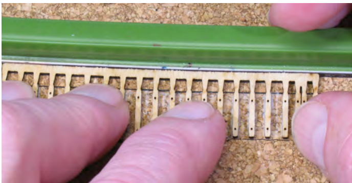
10 Mit Hilfe des Kurvenlineals wird der Schwellenrost bis zum Anbinden des Leims fixiert (gegebenen Falls entsprechend beschweren)
