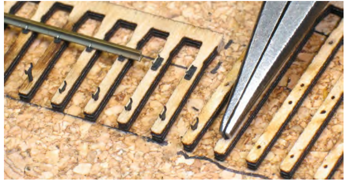
12 Mit einer kleinen Schnabelspitzzange so weit wie möglich nachdrücken...
