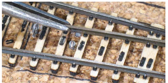
24 Beim Einsetzen der Weichenzungen müssen die verzinnnten Enden der Litzen bündig anliegen...
