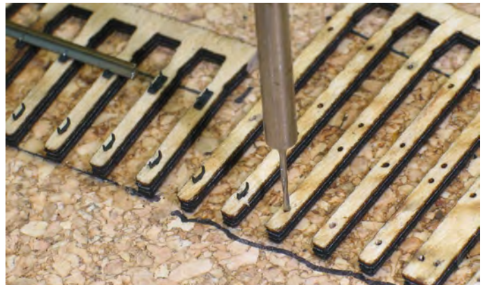
13 Bei nicht gleichmäßigem, oder bei zu viel Leimauftrag kann es zum Verkleben der Bohrungen kommen. Mit einem 0,5 Millimeter-Bohrer wird hier per Hand nachgebohrt. Das erleichtert das Eindrücken der Gleisklammern erheblich.
