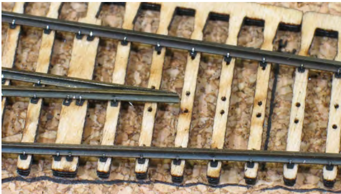
20 Probeweises Einsetzen der beiden zurechtgefeilten Herzstückprofile.
