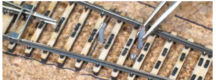
23 Für die elektrischen Anschlüsse des Herzstückbereiches, sowie die der Weichenzungen wurden 1,1 Millimeter-Bohrungen gesetzt, durch die verzinnnte und abgewinkelte Litzen geführt werden.
