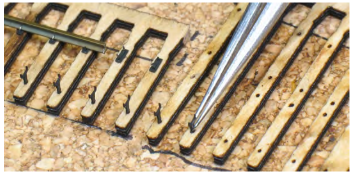
11 Loses einsetzen der Gleisklammern mit einer Pinzette.
