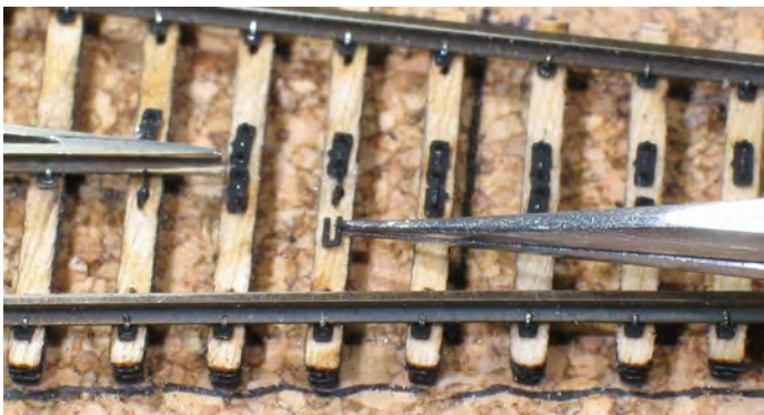
21 Nachdem das Herzstück verlötet wurde, sind die Kleiseisen der Zungen- und Flügelschienen eingesetzt worden. In Bereichen, in denen die Gleisklammern sehr dicht beieinander liegen, müssen die halben Schienenplättchen verwendet werden. Der Kamm des Schwellenrostes wurde mittlerweile auch entfernt.
