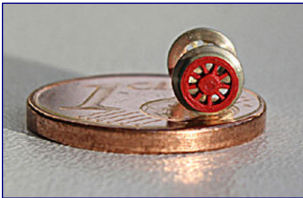
Vorlaufräder mit durchbrochenen Speichen und feinen Radsternen werden künftig viele gesuperte Dampflokmodelle zusätzlich aufwerten. Foto: Michael Bahls
