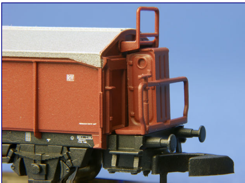
Das eckige Blechbremserhaus der DB ist ein neues Bauteil im Märklin-Baukasten. Die runden Seitenfenster sind nicht durchbrochen ausgeführt; Geländer und Handbremskurbel wirken nicht nur in der Makroaufnahme etwas dick.
