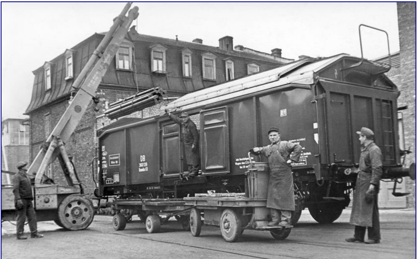
Einer der ersten Serienwagen der Gattung Kmmks 51 (Betriebsnummer 360 139) wird 1952 in Witten entladen. Gut zu sehen ist, wie das geöffnete Hubschiebedach auf Schienen über die andere Dachhälfte läuft. Foto: Willi Marotz, Sammlung Eisenbahnstiftung
