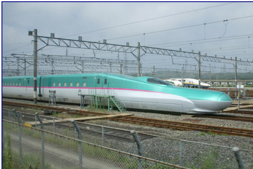
Ein Vorserienzug Reihe E5 der JR East mit seinem extrem stromlinienförmigen Entenschubel steht am 25. Juli 2009 im Shinkansen-Hauptdepot Sendai. Foto: DAJF (CC BY-SA 3.0)
