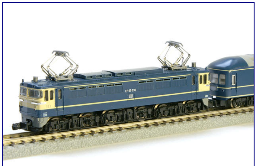
Die Einzelaufnahme lässt einige der Details am Modell der EF65 530 erkennen, darunter die filigranen, aber elektrisch nicht funktionstüchtigen Scherenstromabnehmer.
