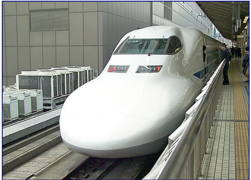
Die Tokaido-Shinkansen-Züge der Baureihe 700 tragen eine optimierte Nase gegen den Tunnelknall. Beim Halt im Bahnhof Tokio ist auch das nahezu viereckige Grundprofil der Wagen gut zu erkennen. Foto: Frank Gualtieri † (PD)
