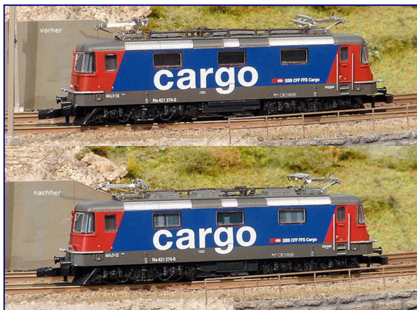
Die zwei Lokansichten verdeutlichen den Unterschied zwischen dem Ursprungszustand und der Superung durch die Papiereinlage. Foto: ZettZeit, Jens Wimmel
