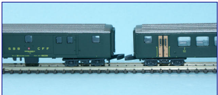
Als kritisch sahen wir ungewollte Entkupplungen im Testbetrieb. Die Gegenüberstellung mit einem 2.-Klasse-Wagen zeigt, dass beim betroffenen Packwagen ein Kupplungskörper minimal nach oben verzogen ist.
