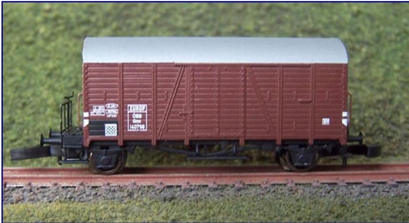
Die ÖBB-Version des gedeckten Güterwagens Bauart Oppeln mit Bremserbühne ist die zweite Variante des neuen Waggons und bereits lieferbar. Foto: FR Freudenreich Feinwerktechnik
