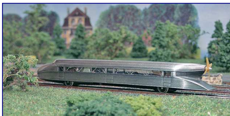
Ein glückloser Versuchsträger blieb Kruckenberg's Schienenzeppelin. Immerhin konnte er aber mit 230 km/h Höchstgeschwindigkeit einen Weltrekord für Schienenfahrzeuge aufstellen. Foto: Götz Guddas
