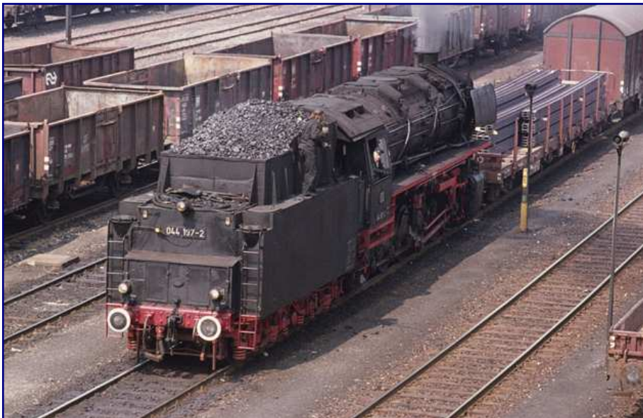
Der große Kessel des Jumbos verschlang sehr viel Kohle. Daher wurden auf den Kohletendern, wie hier auf dem der 044 197-2, häufig Erhöhungen angebracht, mit denen die Ladekapazität erhöht werden sollte. Foto: Eckerle, Sammlung Petkelis
