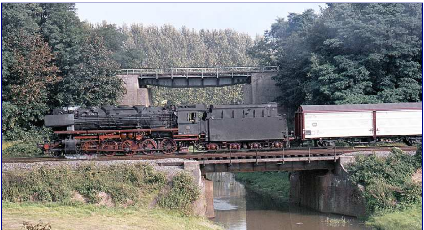
Einen interessanten, gemischten Güterzug befördert 044 247-5 durch das Fichtelgebirge (Bild oben). Er reizt zur Nachbildung im Modell. Die ölgefeuerte 043 574-2 (ex 44 1574) überquert am 14. September 1974 mit dem VW-Zug Dg 65661 die Raddebrücke bei Meppen. Das fehlende, vordere Führerstandsseitenfenster beweist ihren Bau als Kriegslokomotive. Fotos: Eckerle, Sammlung Petkelis (oben) und Peter Schiffer, Sammlung Eisenbahnstiftung (unten)
