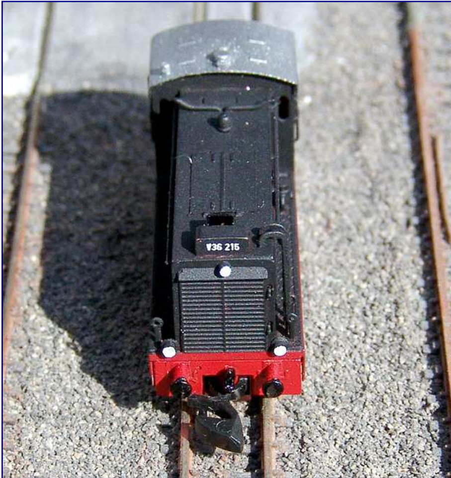
Zum Abschluss ein Blick von oben: Charakteristisch für die modernisierte Lok sind der hohe Kühlwasserausgleichsbehälter und die Auspuffummantelung. Auch die Kraftstoffzufüllrohre („Fahrradlenker“) hinter der Glocke entstammen einer Modernisierungsmaßnahme der DB. Foto: Jens Wimmel
