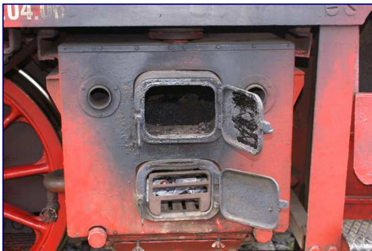
Der von der späteren Bundesbahn eingebaute Dofa-Koksofen verbesserte die Motorvorwärmung der V36 und kam später auch bei der neuen V60 zum Einsatz: Frostschäden und Frieren im Führerstand gehörten endlich der Vergangenheit an.
