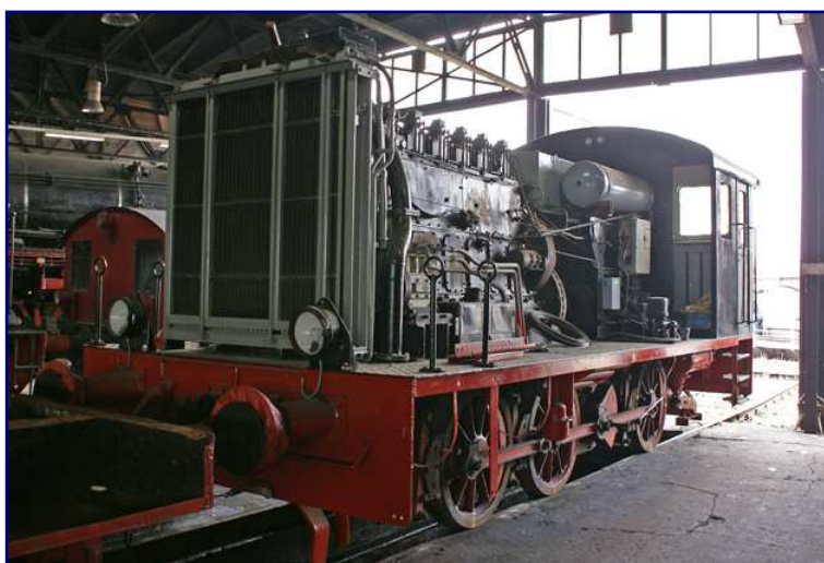
Der Blick unter die Motorhaube einer V36 zeigt (von vorne nach hinten) den Motorkühler, den Dieselmotor sowie direkt vor dem Führerhaus den Kraftstoffbehälter (mittig) und eine der beiden Anlassluftflaschen.
