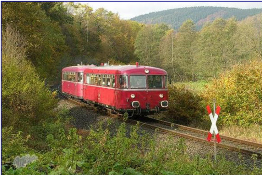
Bald führte die Entwicklung zum zweimotorigen Schienenbus der Reihe VT 98 9 . Die Serienfahrzeuge waren mit normalen, aber leichteren Zug- und Stoßeinrichtungen versehen, um auch einzelne Güterwagen befördern zu können. Sie eroberten die Nebenstrecken in fast ganz Deutschland. Foto: Michael Baier, Betzdorf
