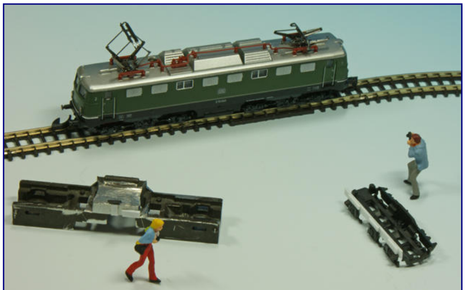
An Märklins E 50 in Ursprungsausführung ist noch kräftig Hand anzulegen, bis aus ihr ein vorzeigbares Fotomodell wird: Der Fahrwerksblock sollte geglättet werden und auf den Drehgestellrahmen muss eine neue Blende aufgebaut werden.
