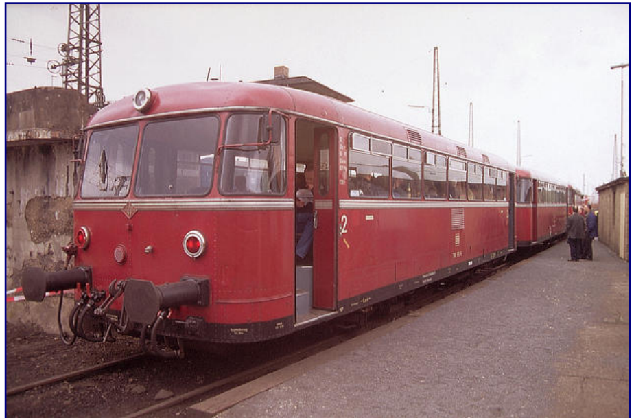
Nicht wenige Einheiten wurden noch für den Einmannbetrieb modernisiert. Man erkennt sie an den Außenspiegeln und den Drückern für die Türöffnung, auf die durch einen gelben Pfeil hingewiesen wurde. Der Lokführer konnte bei den als 796 bezeichneten Garnituren die Türen zentral vom Führerstand aus schließen.
