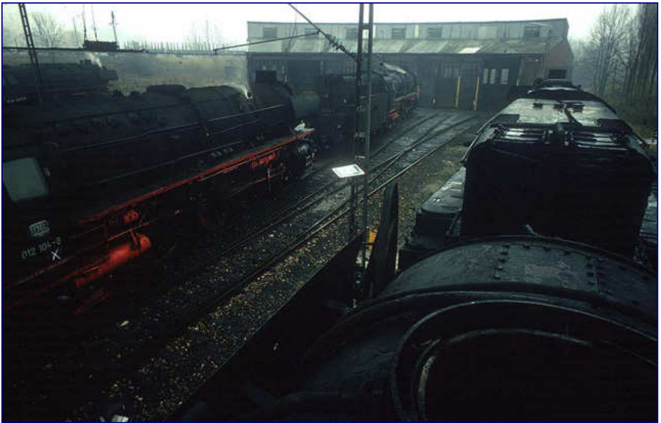
Mehrere ölgefeuerte Schnellzugloks der Baureihe 012 stehen im Jahr 1974 vor dem Neubauschuppen des Bw Rheine, der als Werkstatt mit Achssenke dient (Markierung 5 im Gleisplan). Der neue Lokschuppen mit 7 Ständen ist nicht an die Drehscheibe angeschlossen und wird daher nur über eine Weichenstraße erreicht. Dieses Gebäude blieb nicht erhalten. Foto: Wolfgang Staiger
