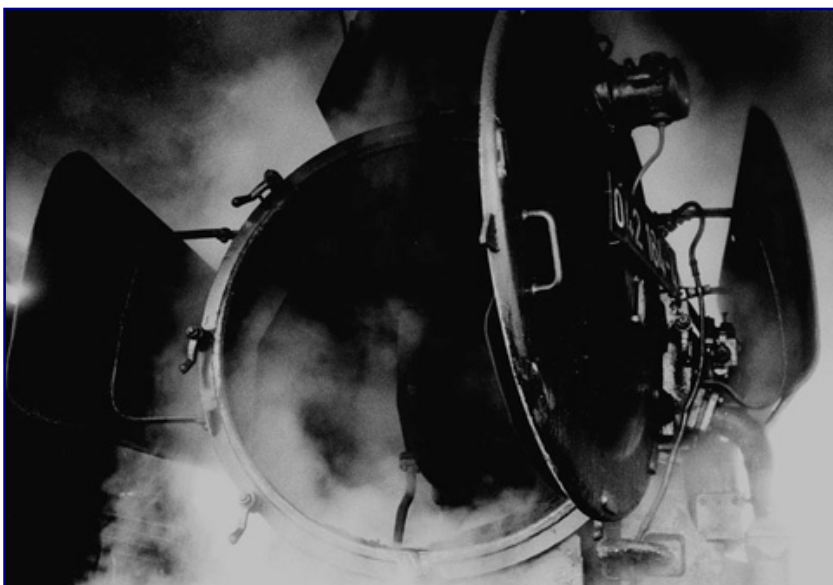
Blick auf die geöffnete Rauchkammertür der 042 164-4. Foto: Wolfgang Staiger
