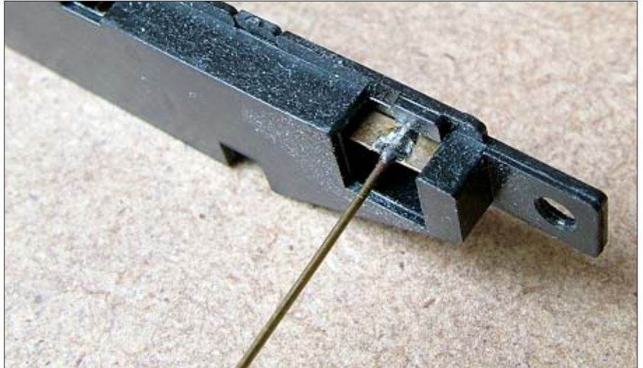
↑ Deutlich sichtbar: der angelötete Stahldraht zum Stellen der Weiche.
