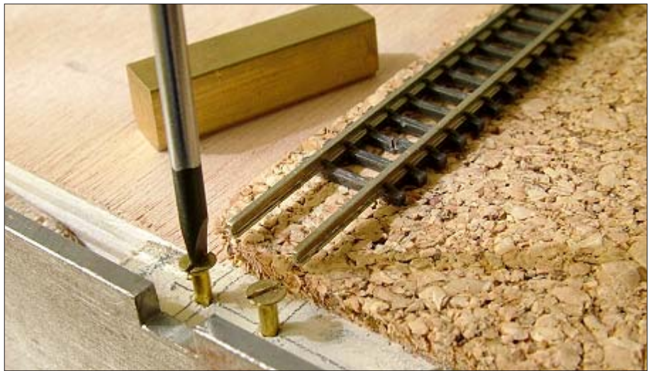
↑ Ist das Gleis nicht bündig mit der Gleislehre, so werden die Schrauben nachgedreht.
