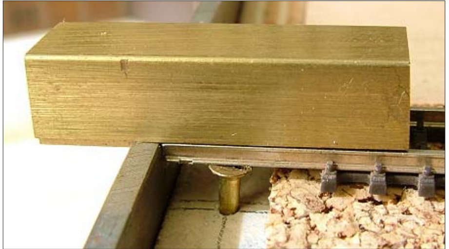
↑ Schienenoberkante und Gleislehre müssen absolut bündig sein.
