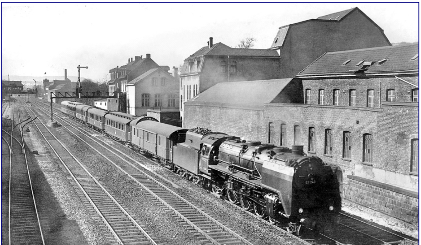
Im April 1938 lichtet Carl Bellingrodt die 03 240 (Bw Osnabrück Hbf) mit D 93 nach Altona Hbf in Wuppertal-Unterbarmen nahe seiner Wohnung in der Siegesstraße 94 ab. Die Lok ist hier mit einem Tender 2'2' T 32 der jüngeren Bauform 1926 zu sehen. Foto: RVM-Filmstelle Berlin (Bellingrodt), Eisenbahnstiftung.
